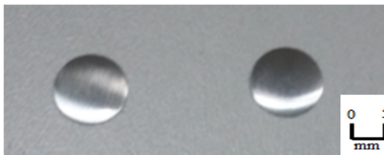
Figura 21- Corpos de prova do ensaio de SPT.
