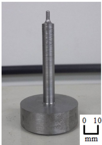
Figura 19- Punção desenvolvido para os ensaios de SPT.
