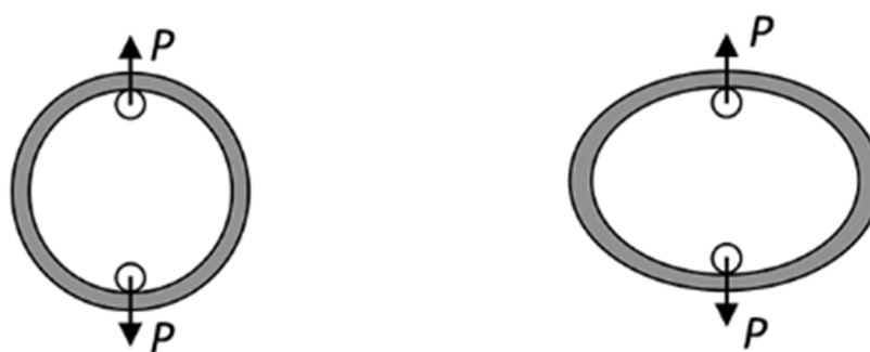
Figura 14- Geometrias de corpo de prova para SRT (HYDE et al. , 2014)
