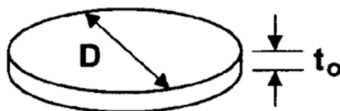
Figura 7- Geometria padrão de amostras para ensaio de SPT (HYDE & SUN, 2011).
